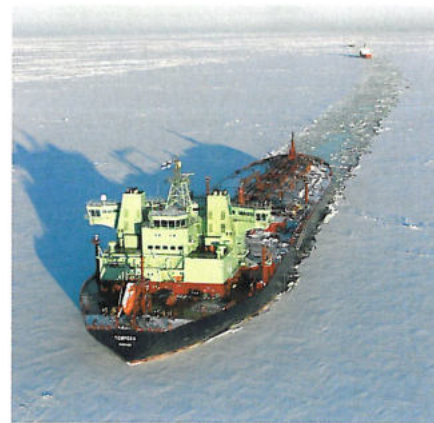
Abb. 15 Sumitomo, Double Acting Tanker, bricht Eis mit zwei Pods rückwärts fahrend, 2 x 10 MW, Azipod Foto: Sumitomo
