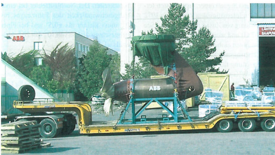
Abb. 16 Compact Azipod, 4 MW wird komplett transportiert und eingebaut
