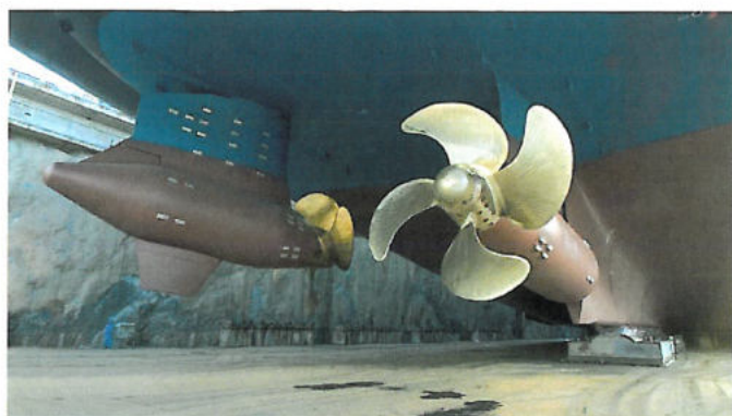
Abb. 11: Backbord- und Mittelpod von »Freedom of the Seas«, 3 x 14 MW, Azipod Foto: Aker Yards Finland
