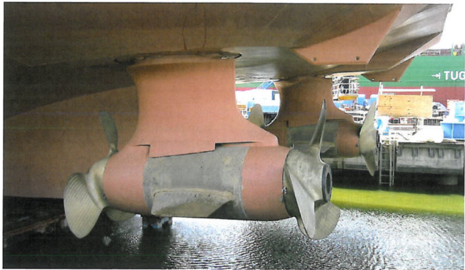
Abb. 17 SEP von Schottel, 2 x 2 MW, Eisrandforschungsschiff »Maria S. Merian«
