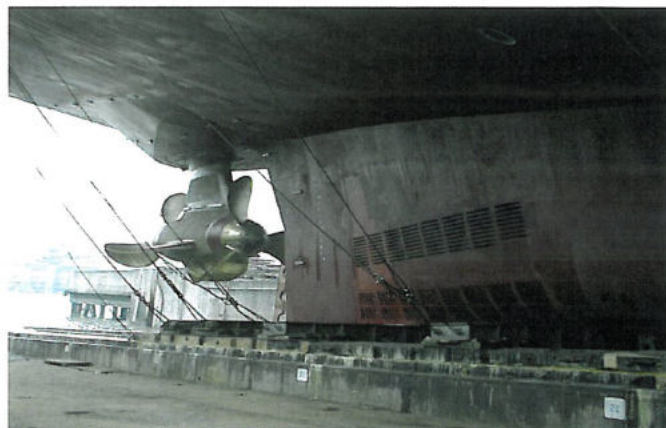
Abb. 14 Chemical Tanker mit 5,1 MW Schottel SSP als alleiniger Antrieb Foto: Schottel
