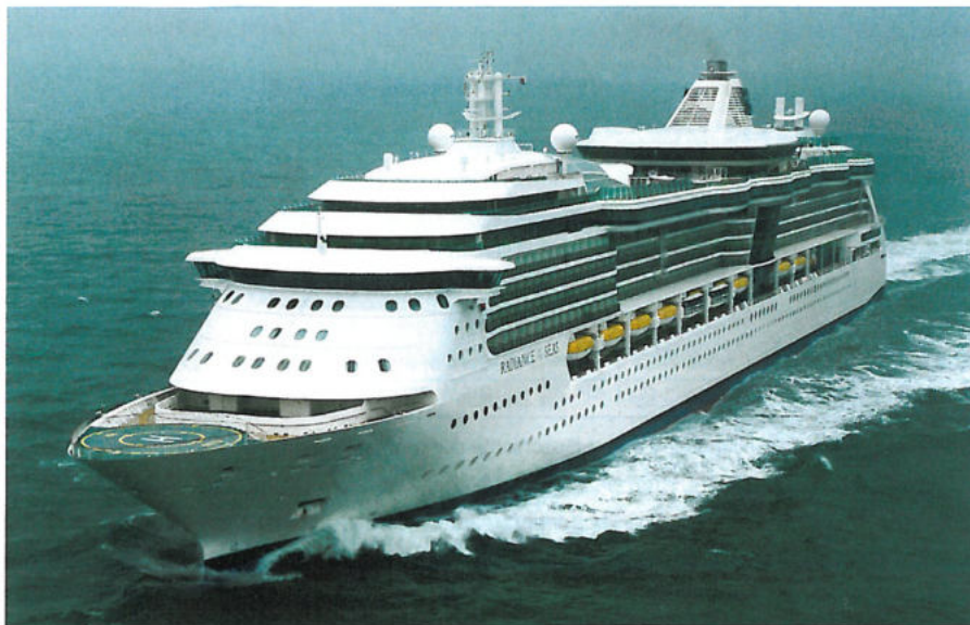
Abb. 7: Kreuzfahrtschiff »Radiance of the Seas« mit 2 Pods je 20 MW, Azipod
