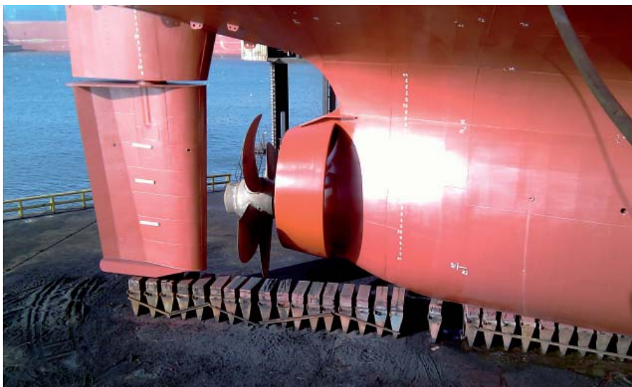
Abb. 2: Mewis Duct® an der „Bow Flora“, einem 40 000 tdw-Chemietanker der Odfjell Tankers, Norwegen
