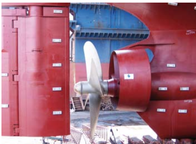
Abb. 2: Die erste montierte Mewis Duct®, „Star Istand“, 47 000 tdw-Open Hatch Cargo Carrier, September 2009 Foto: BMS
