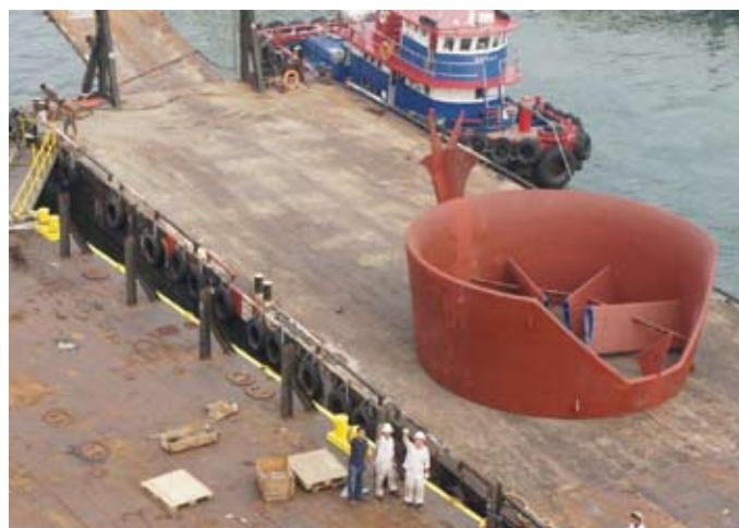
Abb. 3: Die bisher größte Mewis Duct® für ein 318 000 tdw-VLCC (Tanker), Düsendurchmesser außen: 7,91 m; Masse 32,8 t Foto: Mencast Singapur
