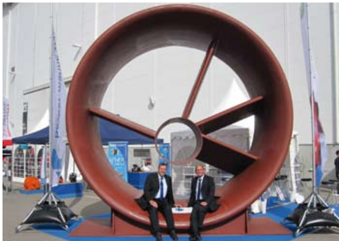
Abb. 1: Mewis Duct® für einen 118 000 tdw-Bulkcarrier auf der SMM 2010, Düsendurchmesser außen 4,66 m
