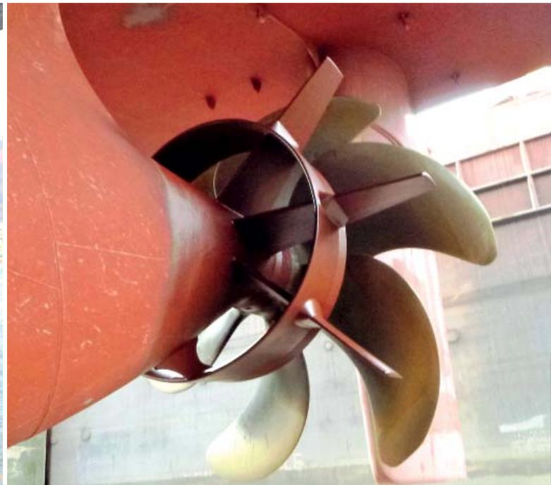
Becker Mewis Duct® Twisted an einem Containerschiff
